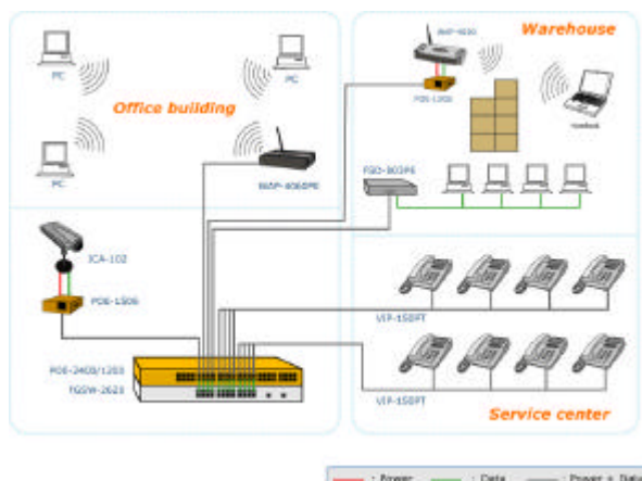
Tipica configurazione PoE secondo IEEE 802.3af
