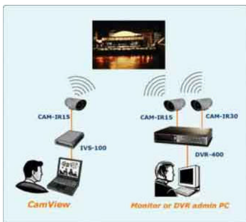
Tipica configurazione Telecamere IR & Video Server
