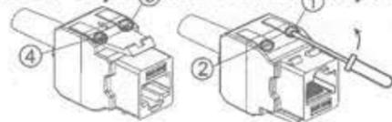
2) Sulle 4 posizioni indicate in figura fare leva con un cacciavite a lama piana per aprire il coperchio di copertura.
