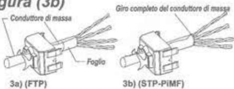
4) Seguendo la colorazione di terminazione T568A/B inserire le coppie nel foro del coperchio copri connessione.
