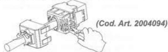
9) Seguendo le "frecce di indicazione inserzione" inserire il coperchio esterno sulla presa connettorizzata.
