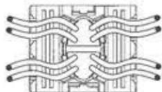
6) Seguendo le indicazioni di fissaggio inserire il coperchio copri connessione sulla presa.
