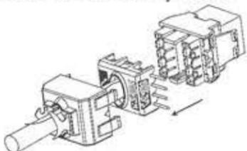
7) Con l'attrezzo CRIMP tool pressare il coperchio copri connessione sulla presa per la chiusura definitiva della connessione.
