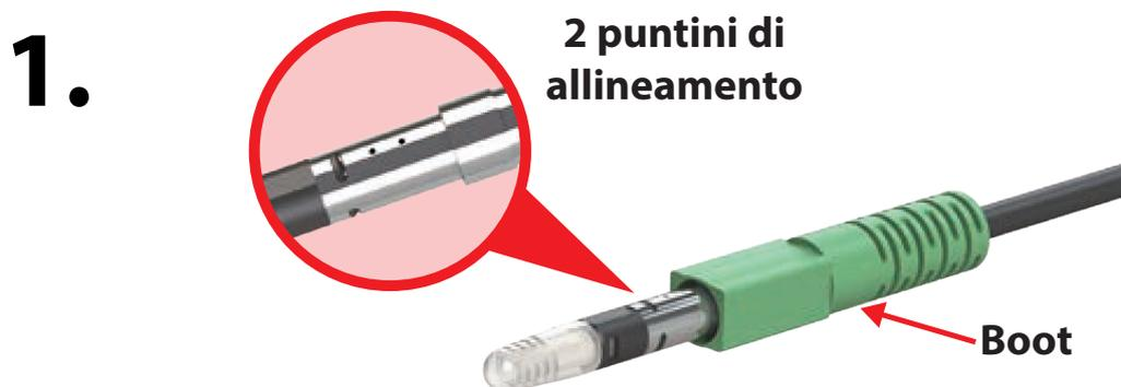
Posizionare il boot davanti al connettore e, seguendo l'allineamento fornito dai due puntini presenti sul corpo del connettore stesso, inserirlo fino a quando non si incastra completamente.
