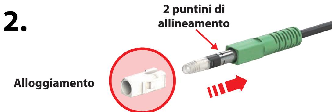
Inserire l'alloggiamento bianco nel connettore seguendo l'orientamento mostrato nell'immagine fino al completo inserimento.
