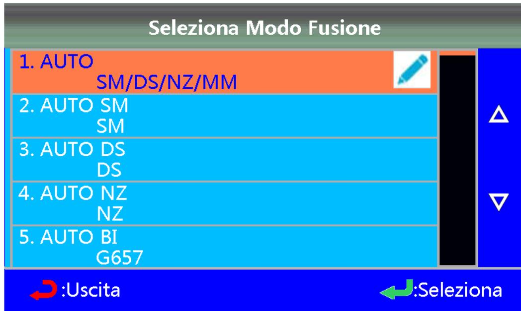
Selezionare un modo di giunzione adatto al tipo di fibra da giuntare.
