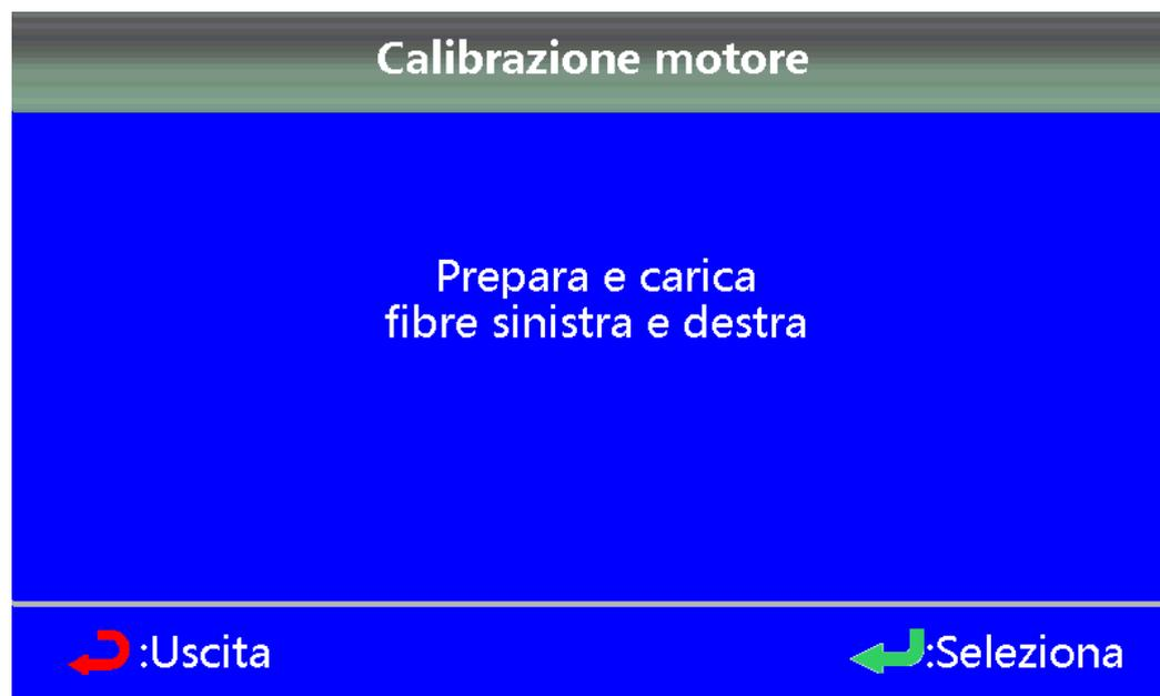
Dopo la "Calibrazione motori", la posizione dei motori verrà regolata automaticamente e alcuni errori di "guasto del motore" verranno risolti per riprendere il normale lavoro.
