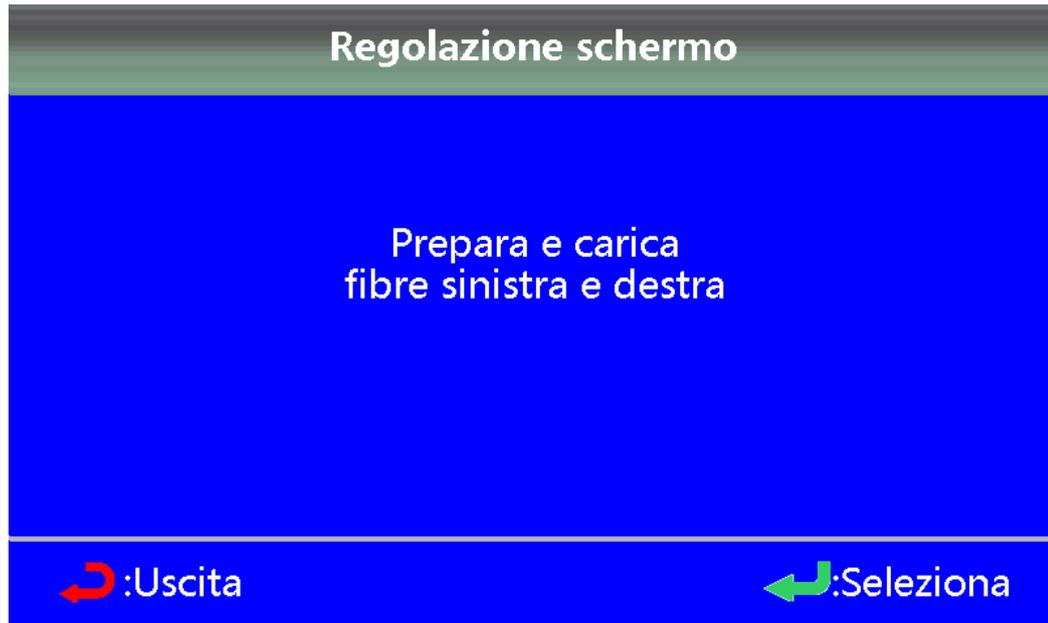
E' necessario posizionare correttamente nella giuntatrice le fibre tagliate.
