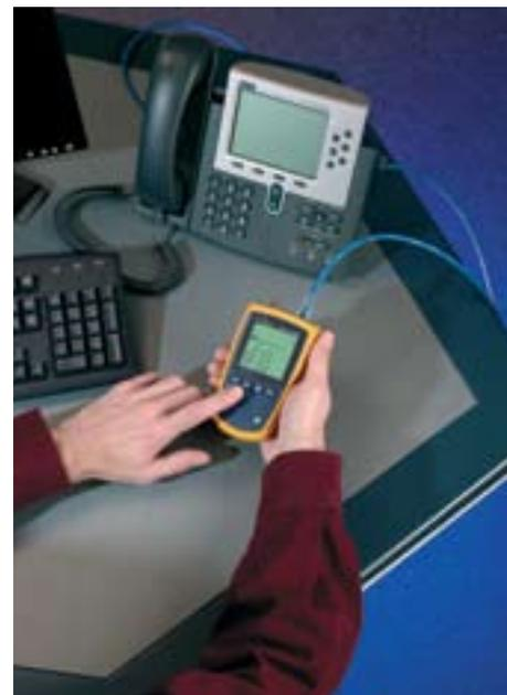
individuazione di qualsiasi cavo o doppino e in qualsiasi ambiente. Utilizzare la modalità digitale per localizzare cavi per dati ad alte prestazioni (Cat 5e/6/6a) in fasci o presso gli switch, i pannelli di connessione o le prese a muro. L'emissione di segnale analogico può essere utilizzata per i cablaggi voce (Cat 3 e inferiore), coassiali, sicurezza/allarme e sistemi audio.
