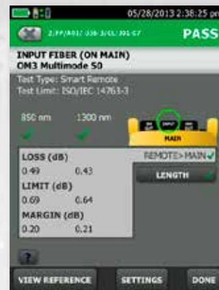
Il dettaglio mostra il margine e i limiti consentiti per la fibra su due lunghezze d'onda.
