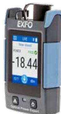
PX1 per la misura dell'attenuazione dei collegamenti in fibra ottica
